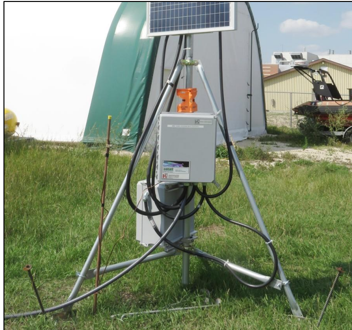
Figure 10. La montchurre dju trépyé avek la bwête d'l'anrjistreuze, partsu la bwête d'la battri an bâ d'la montchurre.
