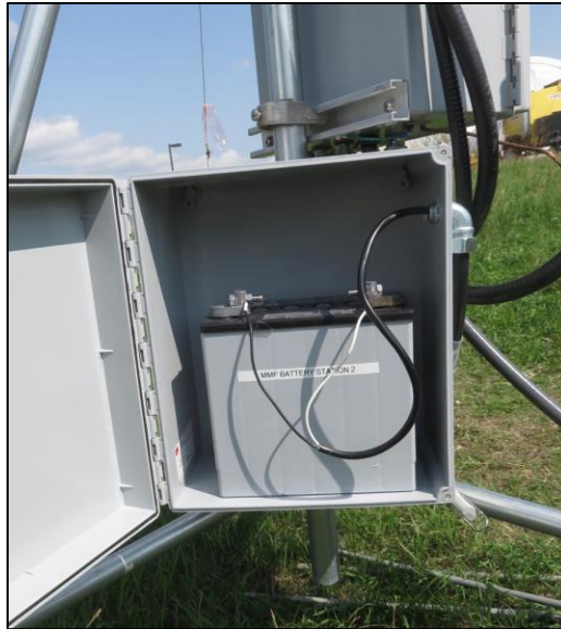
Figure 12. La bwête d'la battri avek enne battri di 12-volt.
