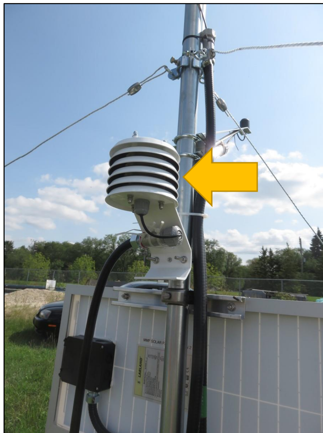
Figure 7. La bwête d'anrjistreuze pour ditekteurre d'la tanpratchurre pi l'umidjiti respektchif, (flèsh jône) li mi su l'kôti norre dju potô, l'ôt barre dju ditekteurre PAR pi partsu l'panô sâlerre.
