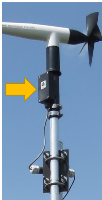
Figure 5. L'ivantaye pour mizuri l'van avek l'kôti larj d'la bwête fasse ô vra Norre pour arranjî la valeurre dju van, kom sâ sa danne li vra djireksyon (flèsh). Li ditekteurre y mizure la djireksyon dju van, la vitesse di rafalle pi la vitesse dju van.
