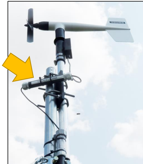
Figure 4. Anémomètre placé au haut d'un tube distinct qui est installé sur le mât. Le connecteur doit être installé à l'horizontale (flèche). Ce capteur mesure la direction du vent, la vitesse de rafale et la vitesse du vent.
