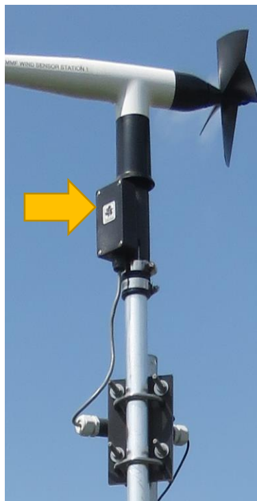
Figure 5. Anémomètre dont le côté large de la boîte est orienté plein nord pour corriger la valeur du vent afin d'indiquer les directions vraies (flèche). Ce capteur mesure la direction du vent, la vitesse de rafale et la vitesse du vent.
